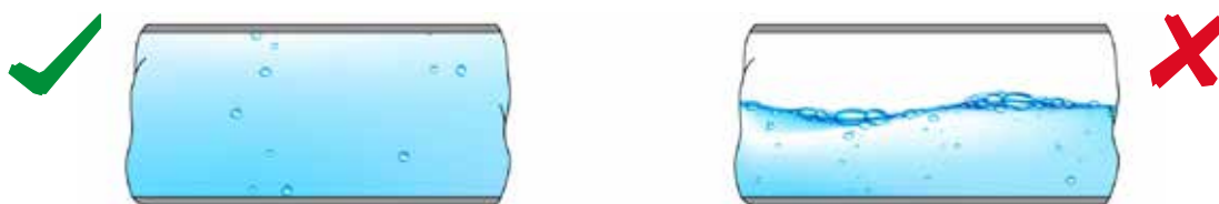
Fig. 5 Le tuyau doit être entièrement rempli de liquide
