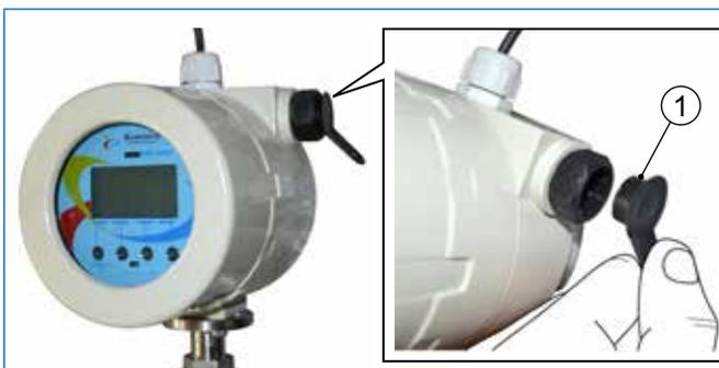
Fig. 38 Activación Magnética de MC608B/R
