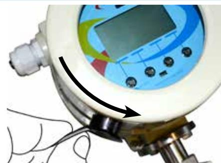
Fig. 39 Activación del MC608B/R
